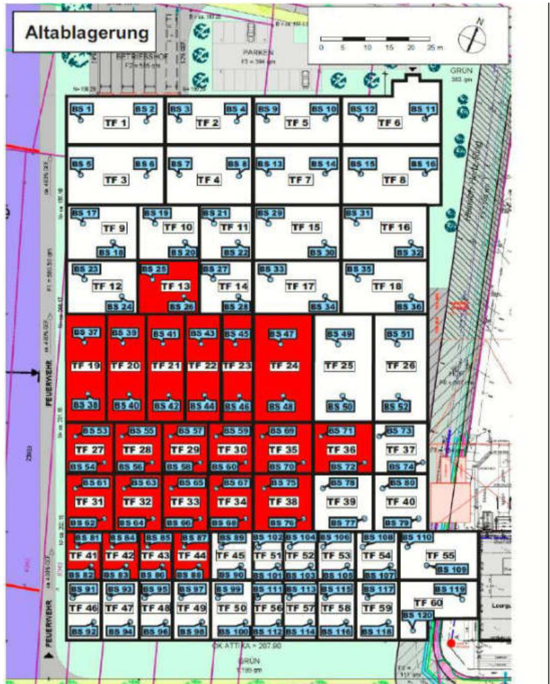
**Abb.17:** Abgrenzung der Altablagerung (rot) und der Baggerschürfe (Planausschnitt GEOTECHNIK SÜDWEST, 2020)
